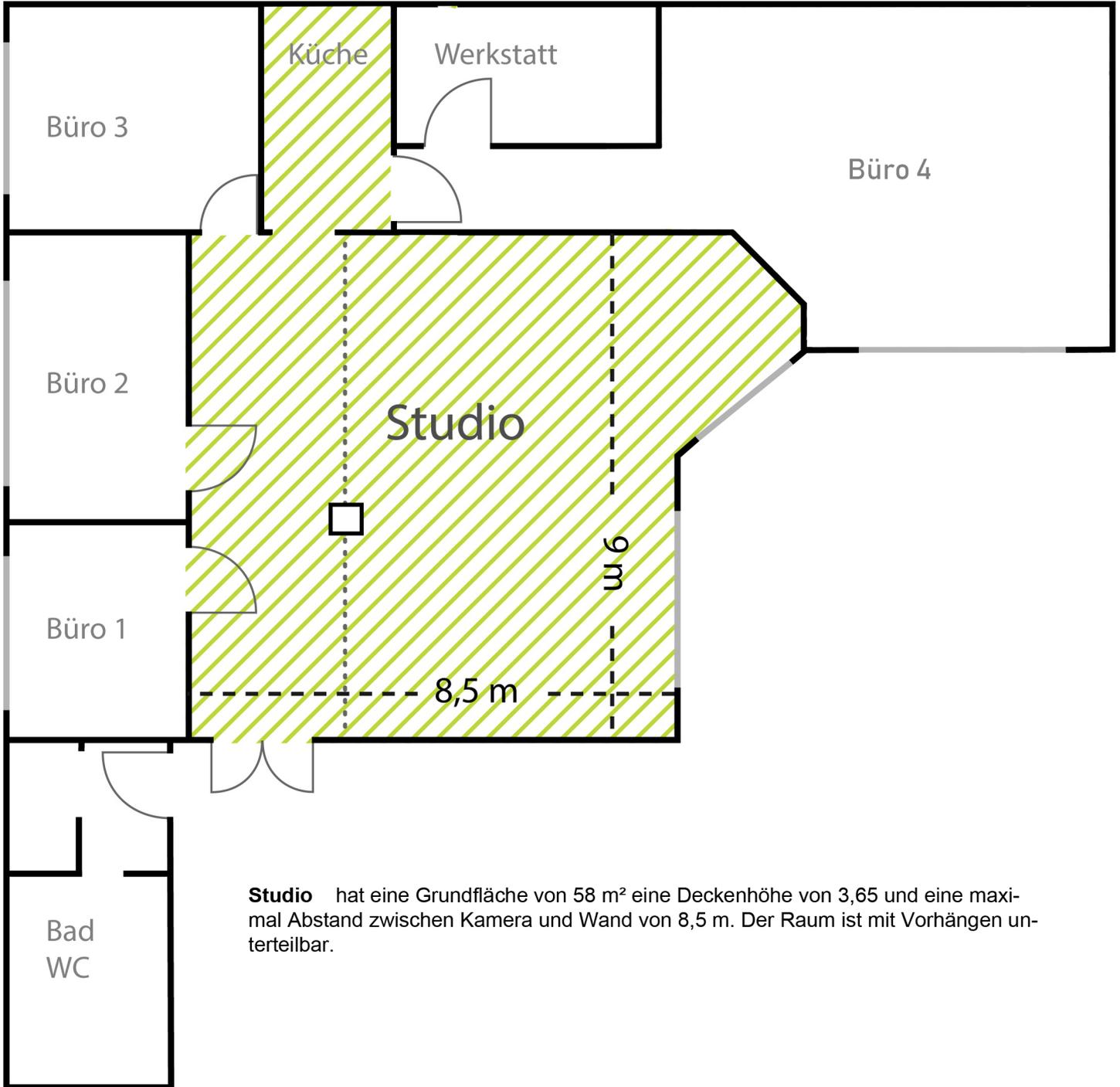
**Studio** hat eine Grundfläche von 58 m<sup>2</sup> eine Deckenhöhe von 3,65 und eine maximalen Abstand zwischen Kamera und Wand von 8,5 m. Der Raum ist mit Vorhängen unterteilbar.
